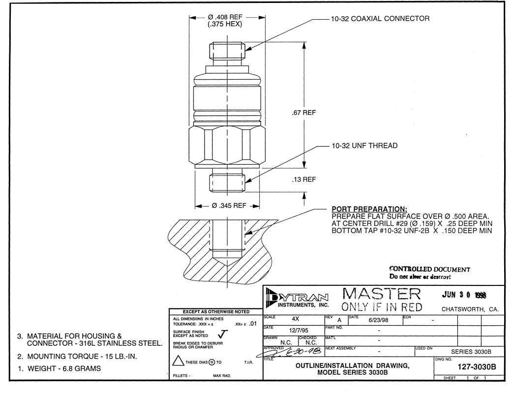
**Model Number** DOC NO PERFORMANCE SPECIFICATION 3030B5 PS3030B5 MINIATURE IEPE ACCELEROMETER REV C, ECN 7958, 10/24/11
